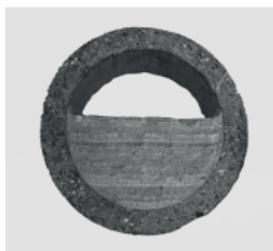
Verkalkte Wasserleitung nach 10 Jahren ohne Reinigung.
